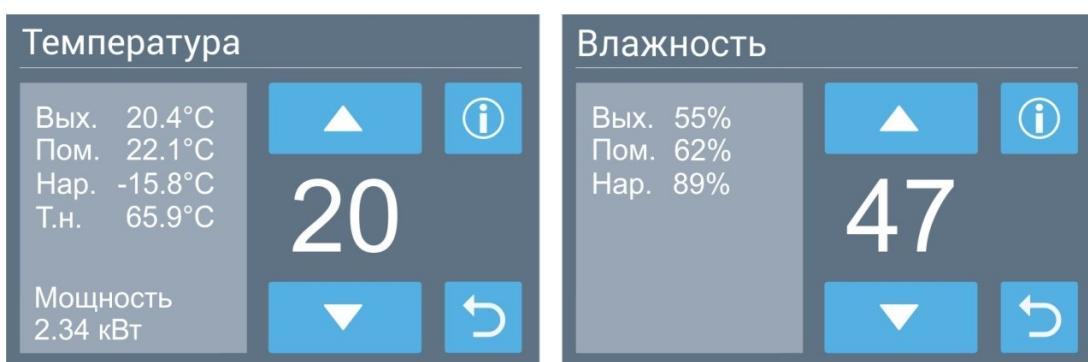
Для изменения температуры, влажности (доступно только при наличии увлажнителя) или скорости вентилятора (может быть недоступно в режиме VAV) нажмите на область, где отображается этот параметр.
