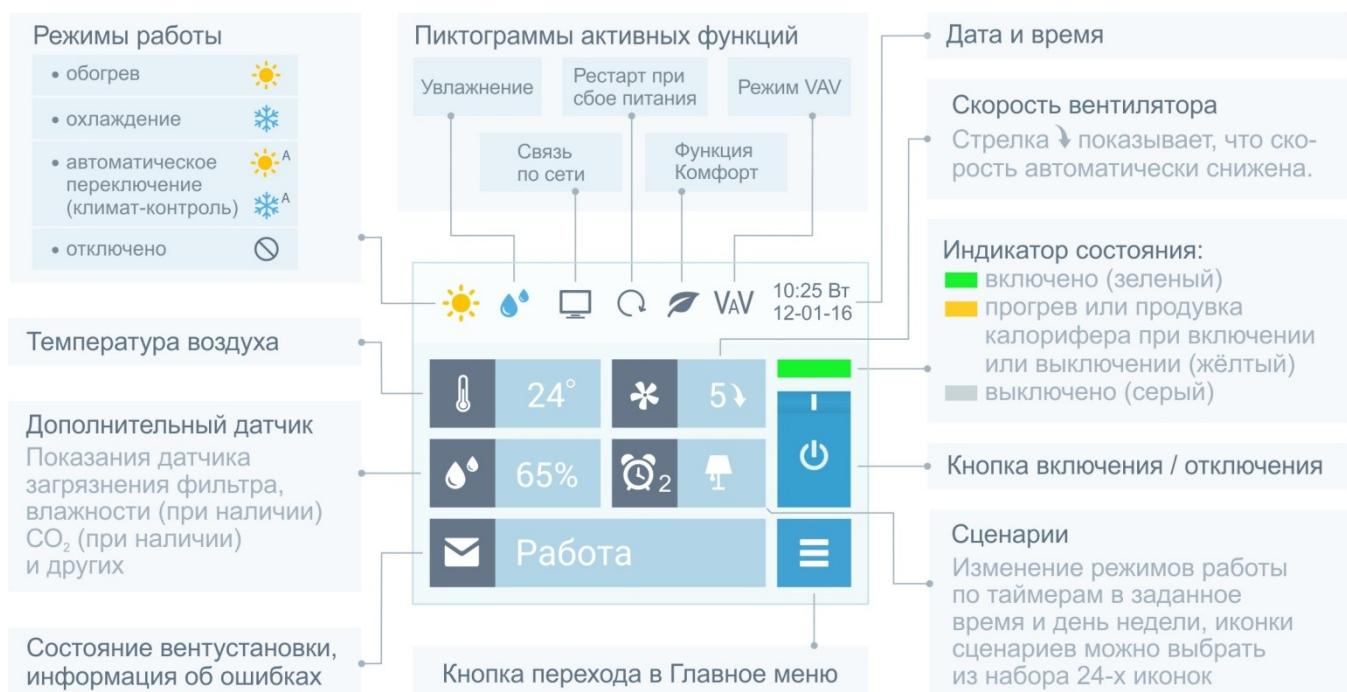
Все области экрана доступны для нажатия – это позволяет быстро переходить к просмотру и редактированию отображаемых параметров: даты и времени, режима работы, сценариев, температуры, влажности и скорости вентилятора.
